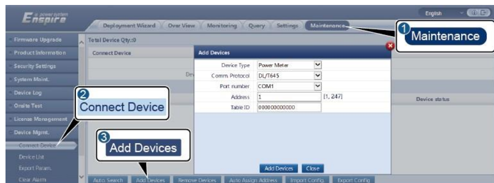
6-22. ábra A hozzáférési paraméterek beállítása
