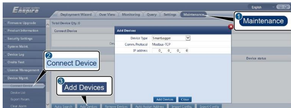
6-14. ábra A hozzáférési paraméterek beállítása
