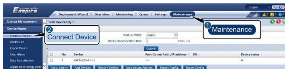
6-15. ábra A beépített MBUS paramétereinek beállítása
