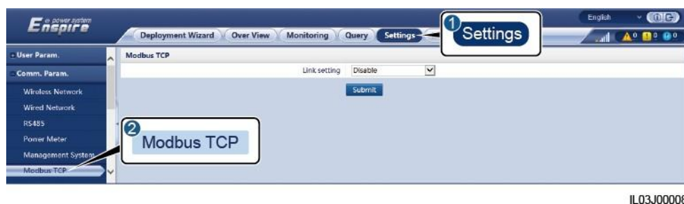
6-13. ábra A Modbus TCP paramétereinek beállítása
