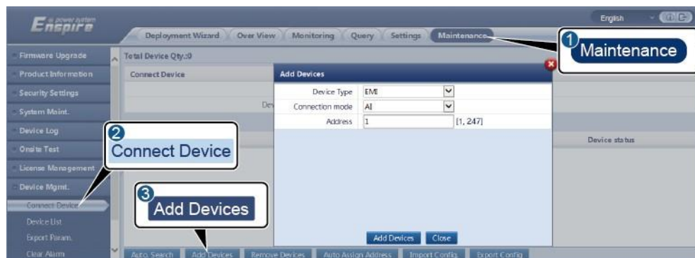
6-28. ábra A hozzáférési paraméterek beállítása
