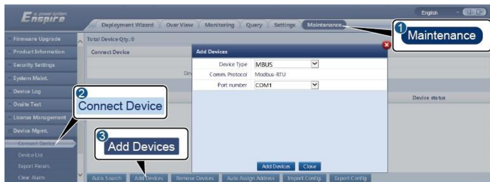
6-16. ábra A külső MBUS hozzáférési paramétereinek beállítása
