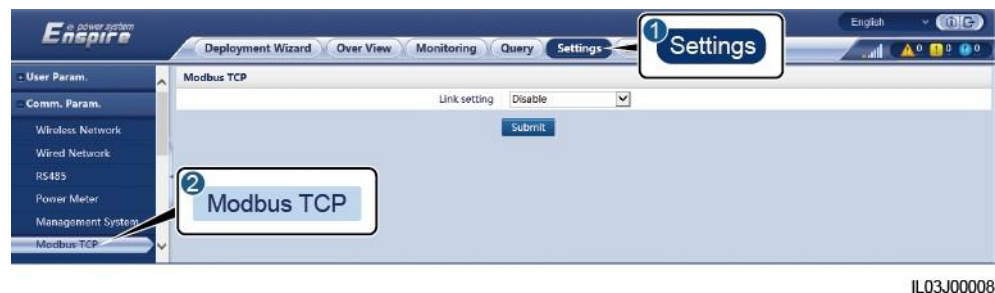
6-10. ábra A Modbus TCP paramétereinek beállítása
