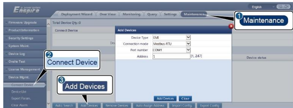
6-26. ábra A hozzáférési paraméterek beállítása
